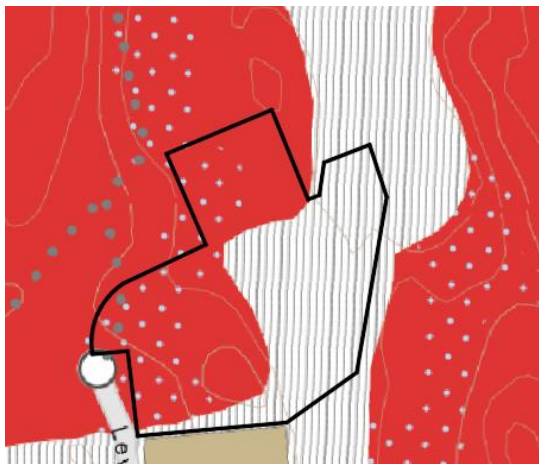
Figur 3 ett utdrag från SGUs jordartskarta visar förekomst berg (rött fält), ibland täckt av ett moränlager (ljusblå prickar) men till största delen ett lager fyllning (vitt fält med grå ränder). Angränsande gulfärgade marklager visar förekomsten av glacial lera.
