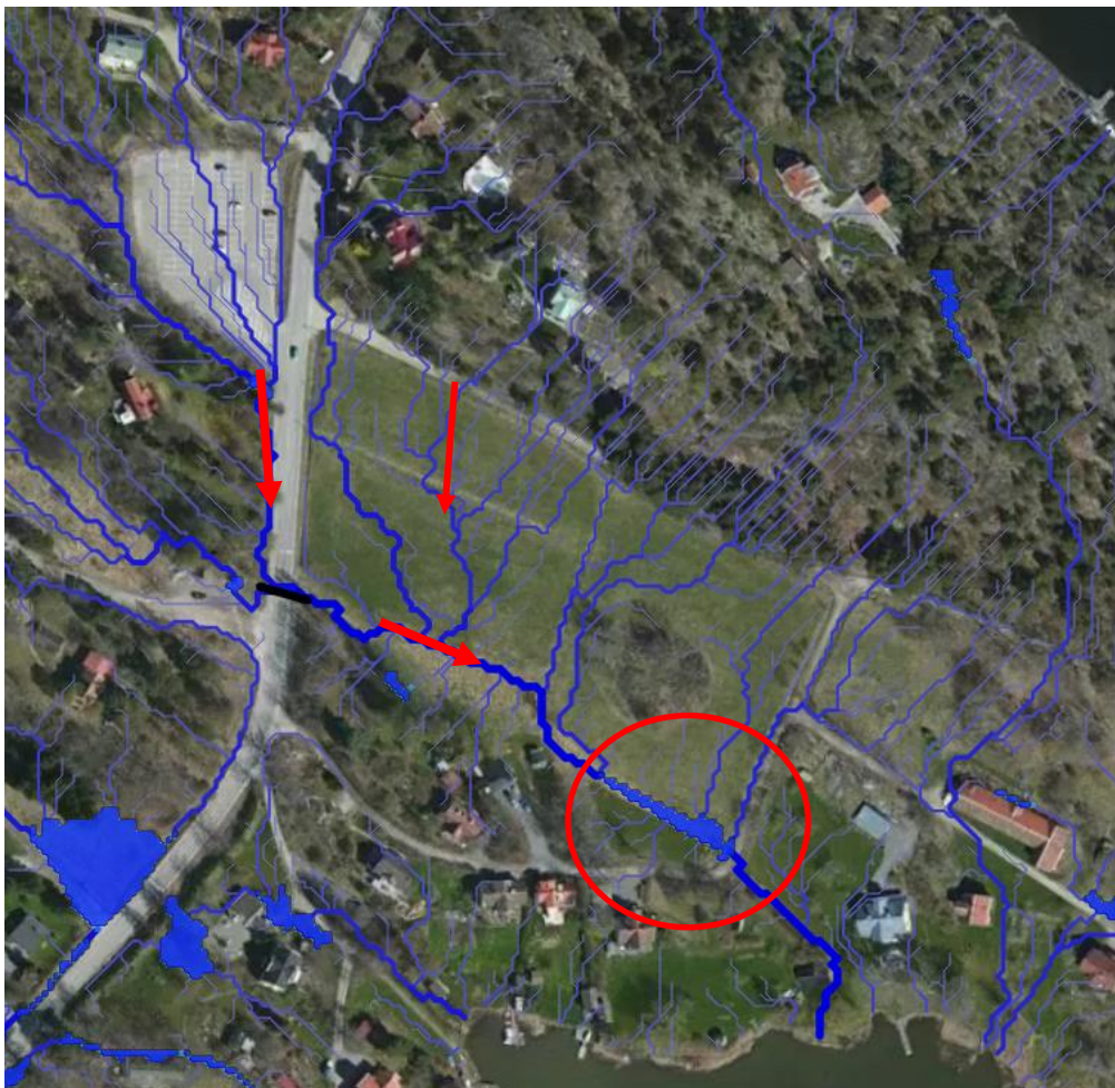
Figur 6. SCALGO analys av lågpunkter i närområdet till fastighet Norra Lagnö 1:380. Relevant lågpunkt är markerat med en röd cirkel i figuren. De röda pilarna visar på flödesriktningen. Hämtat från SCALGO Live 2019-08-16
