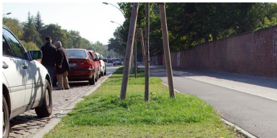
Figur 13: En vanlig gräsmatta eller annan naturmark kan användas för att fördröja och rena dagvattnet.
