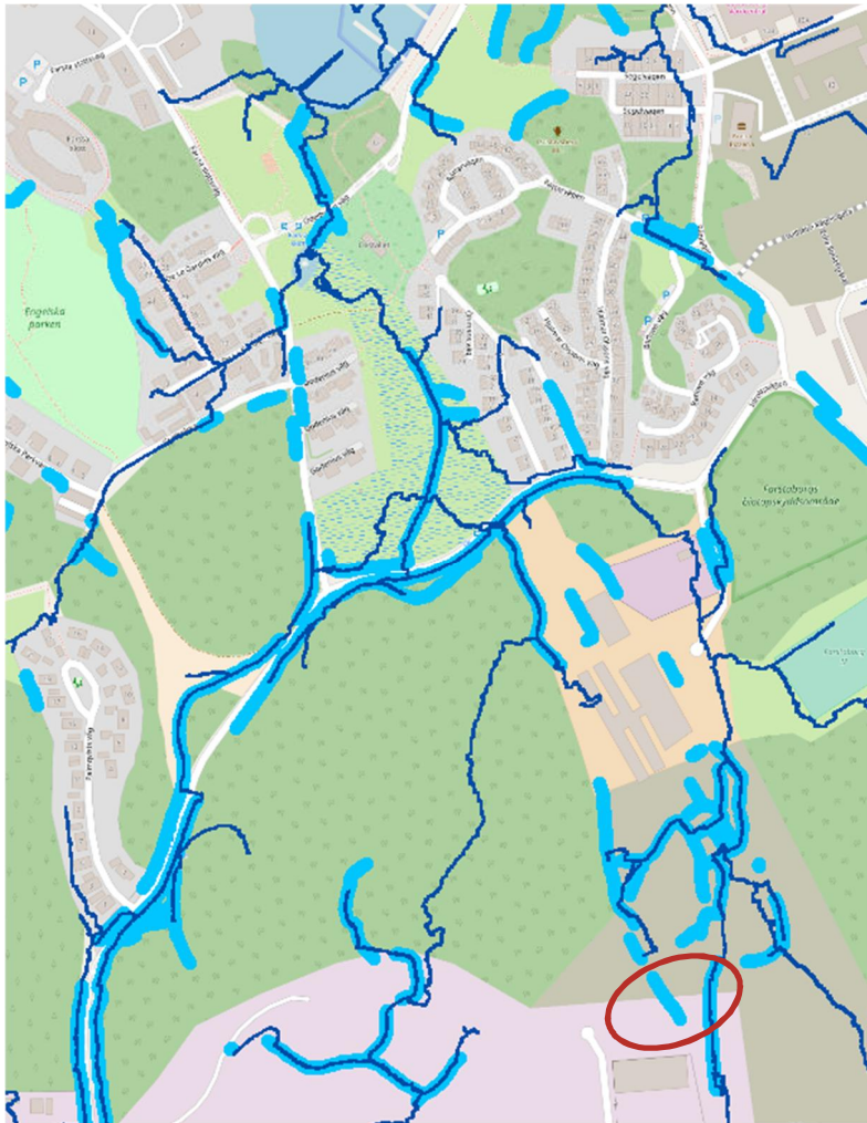
Figur 6 Avledning av dagvatten från planområdets avrinningsområde går via många diken, enligt kommunens underlag, dikesstråk markeras här i ljusblått och flödesvägar från höjdanalysen i mörkblått. Planområdets placering är markerad med en röd ring.
