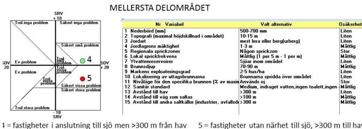
Figur 3.8.12 RV-beräkning av sannolikheten för salt grundvatten i Eksjön. Beräkningen visar att sannolikheten är måttlig till stor för förekomst av salt grundvatten. Punkt 1-3 visar sannolikheten på olika avstånd från hav med en påtaglig risk för strandnära fastigheter. I det mellersta delområdet (undre figuren) visas sannolikheten istället i anslutning till en sötvattenreservoar (4) respektive om det inte finns någon sådan reservoar (5). De medtagna variabelerna och deras osäkerhet visas till höger.
