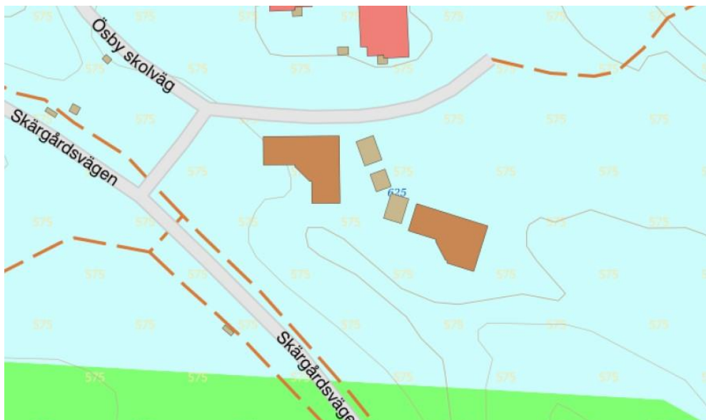
Figur 3. Utdrag ur SGU:s berggrundskarta, 1:1miljon, där enhet 625 motsvarar: metagråvacka, glimmerskiffer, grafit- och/eller sulfidförande skiffer, paragnejs, migmatit, kvartsit, amfibolit.
