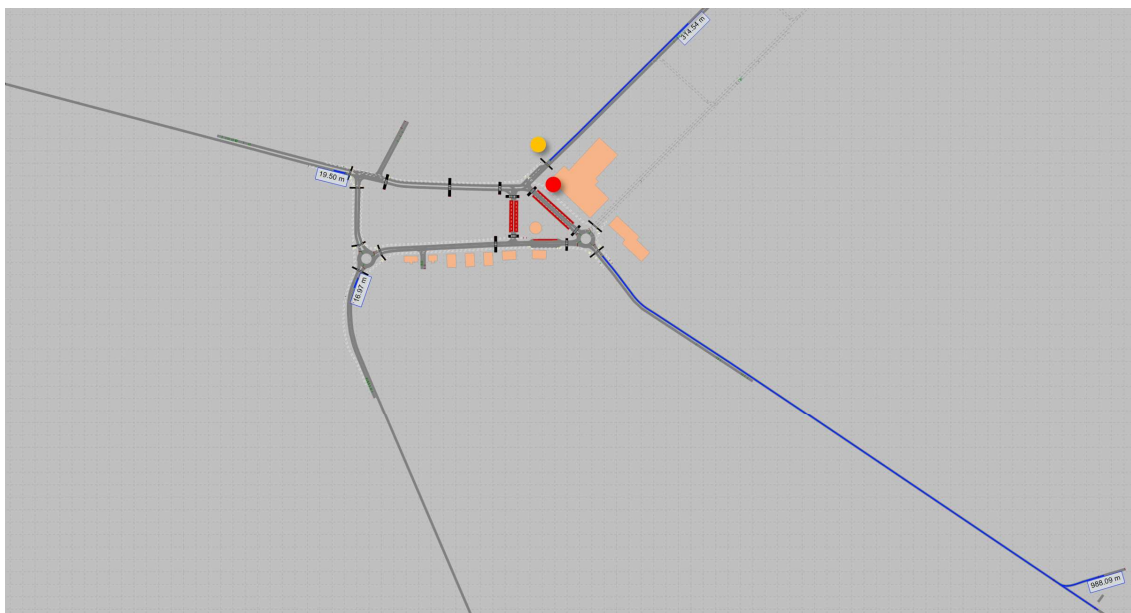
Figur 15 Alt 0B_1, köutbredning 90-petcentil (meter). Röd punkt markerar kraftig flaskhals, orange punkt mindre flaskhals.
