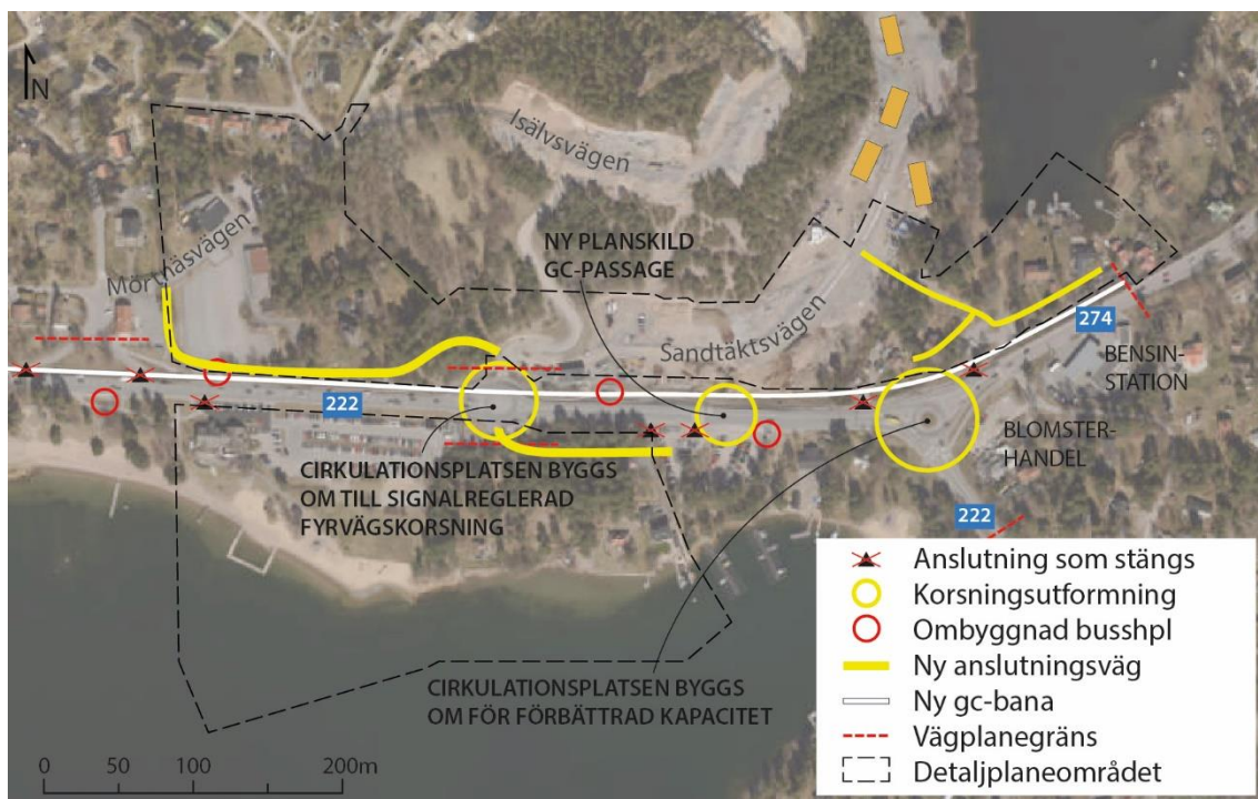
Figur 5: Översikt, vägplanens föreslagna åtgärder
