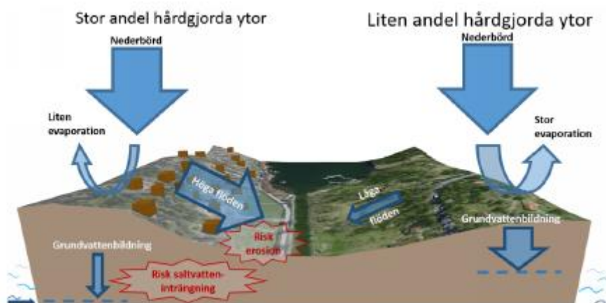
Figur 54: Schematisk skiss över vattenbalansen vid stor andel hårdgjorda ytor och vid liten andel hårdgjorda ytor.
