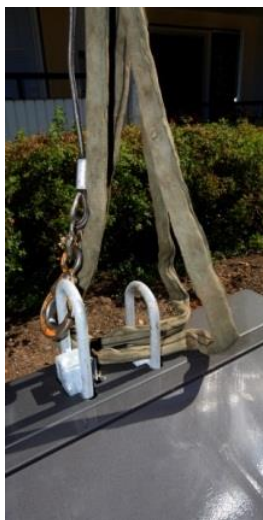
Två-krokssystemet för kranbilen att angöra vid tömning.
