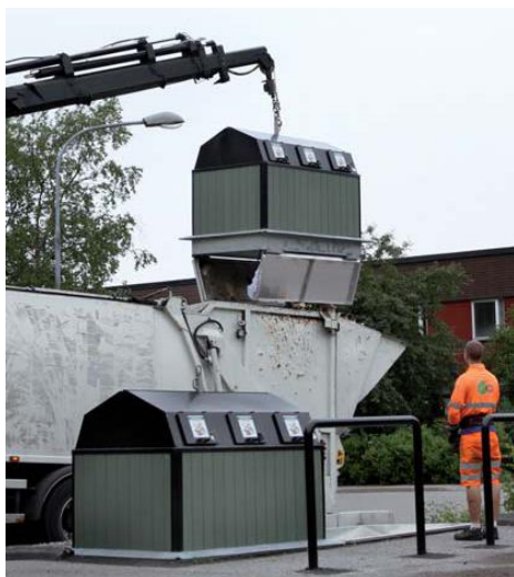
Tömning av SANSACs bottentömmande markbehållare med kranbil.
