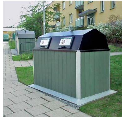
Bottentömmande markbehållare med två-krokssystem från SANSAC
