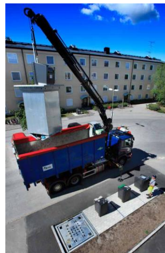
Tömning av PWS underjordsbehållare med kranbil.
