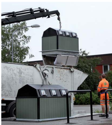
Tömning av SANSACs botten tömmande mark-behållare med kranbil.
