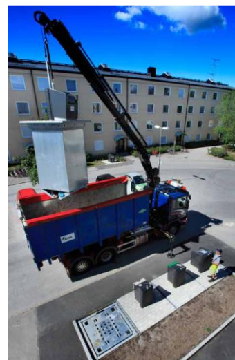
Tömning av PWS underjords-behållare med kranbil.
