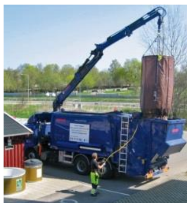
Bild 7: Tömning av Molok@ behållare med innersäck.
