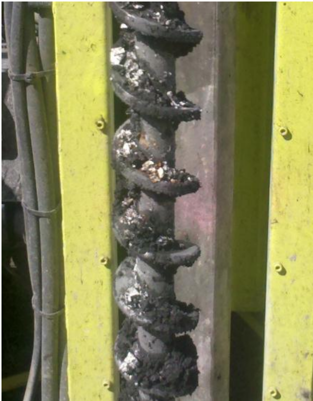
Figur 5. Porslinskross uppblandat med fyllnadsmaterial på skruvborr.
